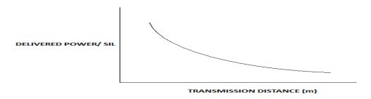
THE CHARACTERISTICS CURVE OF DELIVERED POWER/SIL Vs. TRANSMISSION DISTANCE
